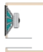
Рис.6. Корпус с фазоинвертором
